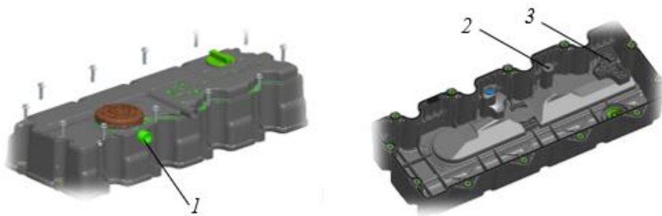
Рисунок 3.38. Крышка головки цилиндров
