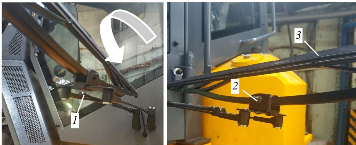
Рисунок 3.16. Замена щетки стеклоочистителя
