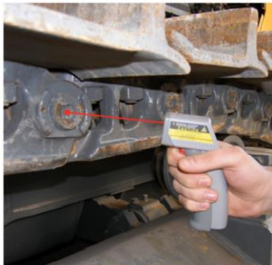
Рисунок 12.51. Измерение температуры втулки при помощи пирометра
