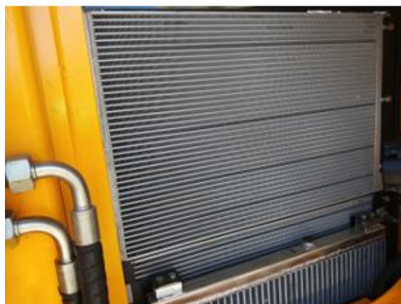
Рисунок 3.75. Блок радиаторов со стороны защитной решетки радиатора
