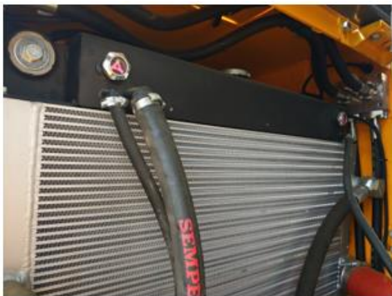
Рисунок 3.74. Блок радиаторов со стороны двигателя
