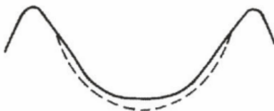
Рисунок 12.75. Износ внутри вершин зубьев
