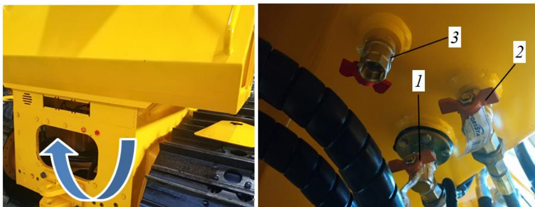
Рисунок 3.49 Размещение запорных кранов на топливном баке
