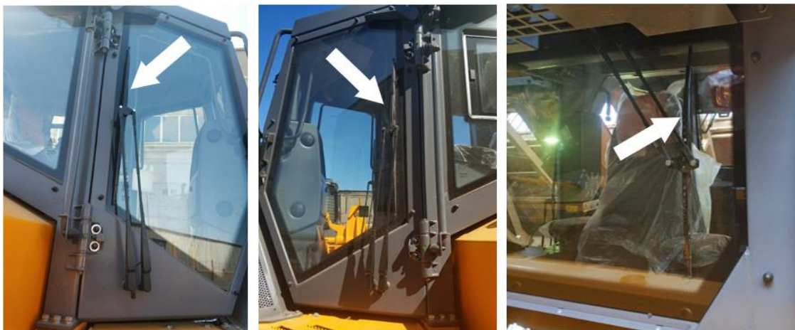
Рисунок 3.14. Размещение щеток стеклоочистителя на окнах кабины
