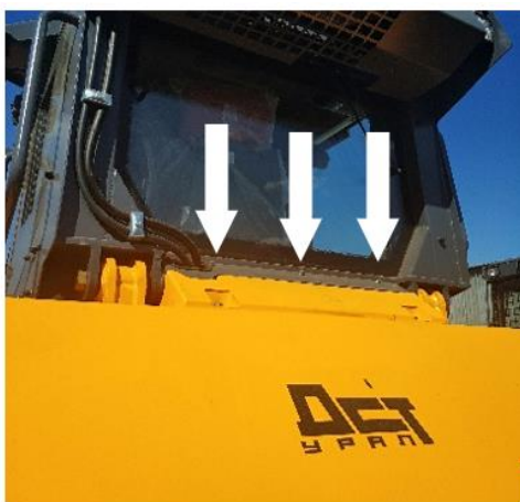
Рисунок 3.93. Размещение крепежных винтов декоративной планки
