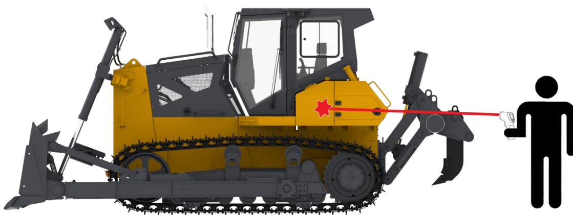
Рисунок 3.159. Измерение температуры гидравлического масла
