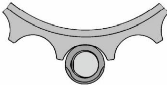
Рисунок 12.48. Положение валика и втулки в сегменте зубчатого колеса
