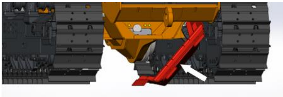
Рисунок 3.89. Откидывающаяся крышка передней брони
