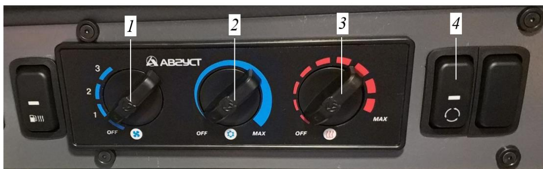
Рисунок 3.149. Панель управления климатической системы кабины оператора
