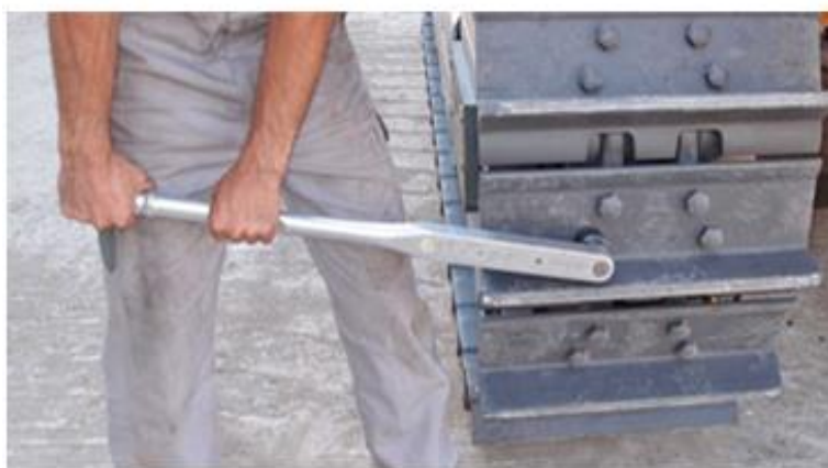
Рисунок 3.121. Проверка затяжки крепежа бабмаков звеньев гусеницы
