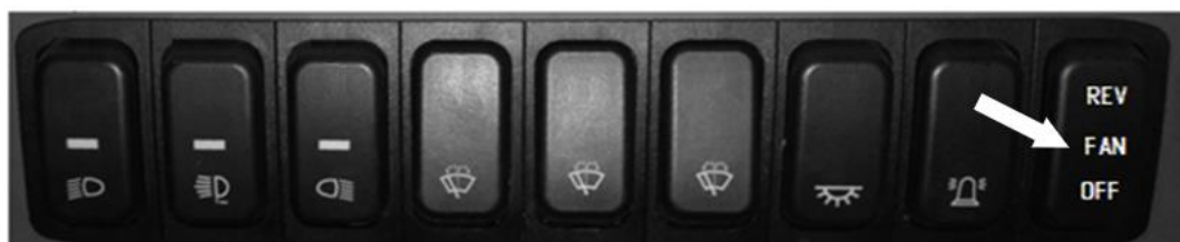
Рисунок 3.76. Щиток переключателей правый верхний (стрелкой показана трехпозиционная клавиша Fan Drive)
