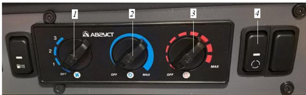
Рисунок 15.11. Панель управления климатической системой
