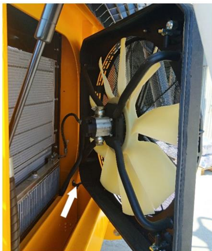
Рисунок 3.78. Рама вентилятора открыта, упор установлен
