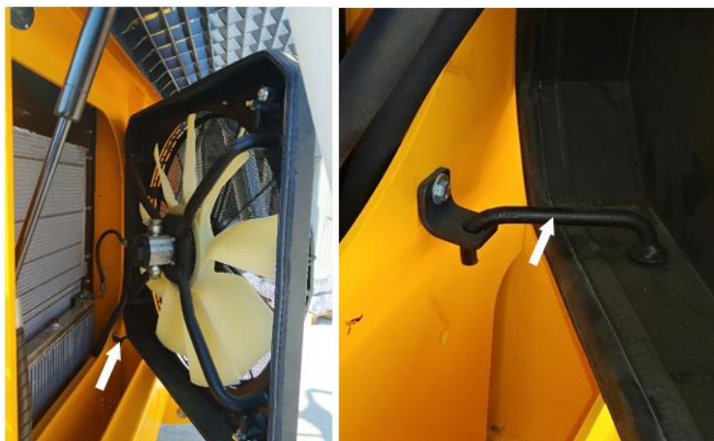
Рисунок 3.73 Фиксация рамы вентилятора в открытом положении (стрелками показано место расположение упора)
