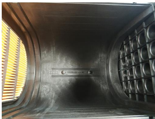
Рисунок 3.58. Внутренняя полость корпуса под установку основного фильтра
