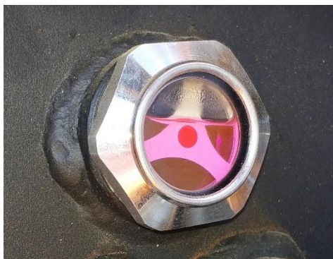
Рисунок 3.95. Смотровое окно расширительного бачка (проверка уровня охлаждающей жидкости в системе охлаждения)
