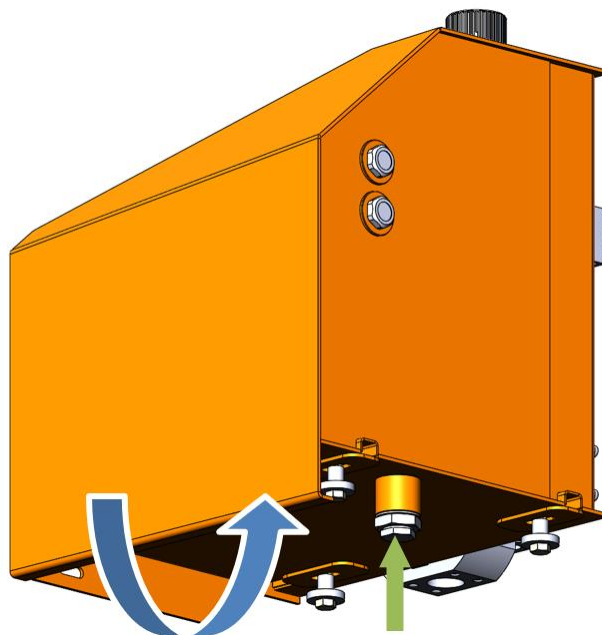
Рисунок 3.98. Сливная пробка на гидравлическом баке
